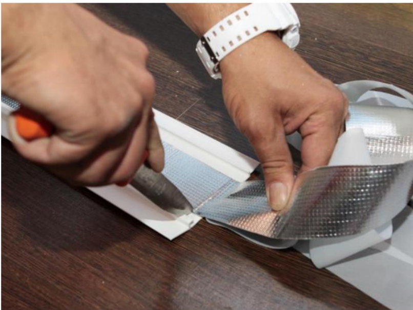
Рис. 33. Край ленты подрезается
